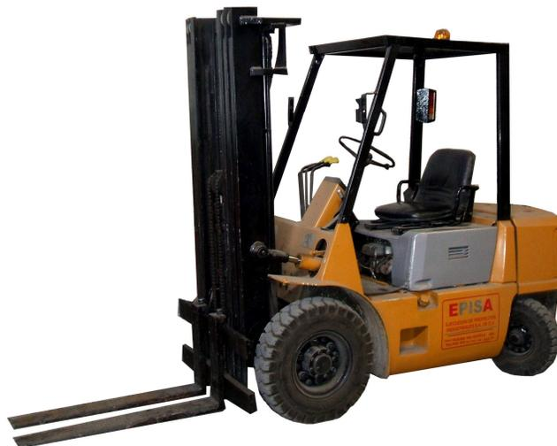
Descripción de montacargas: capacidad carga es de 4 toneladas, levanta 15 pies de alto.
