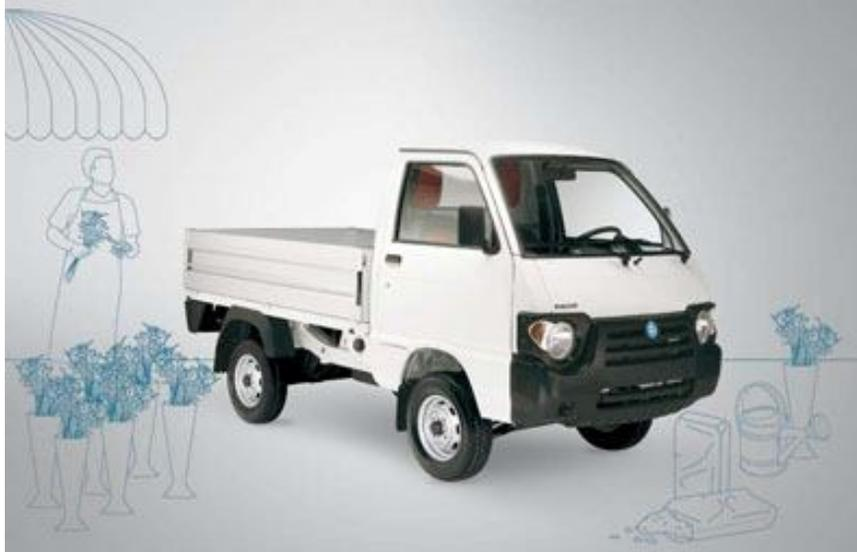
Descripción de la nueva flota de transporte: Pick Up top deck, Minitruck tiene una gran caja de carga de fácil acceso gracias a la reducida altura del plano de carga a tierra hará mas fácil transportar palets de gran altura. Económico y potente modelo 2009 carga 4 toneladas, dimensiones: 3540 x 1395 x 1765 mm, para 2 pasajeros.
