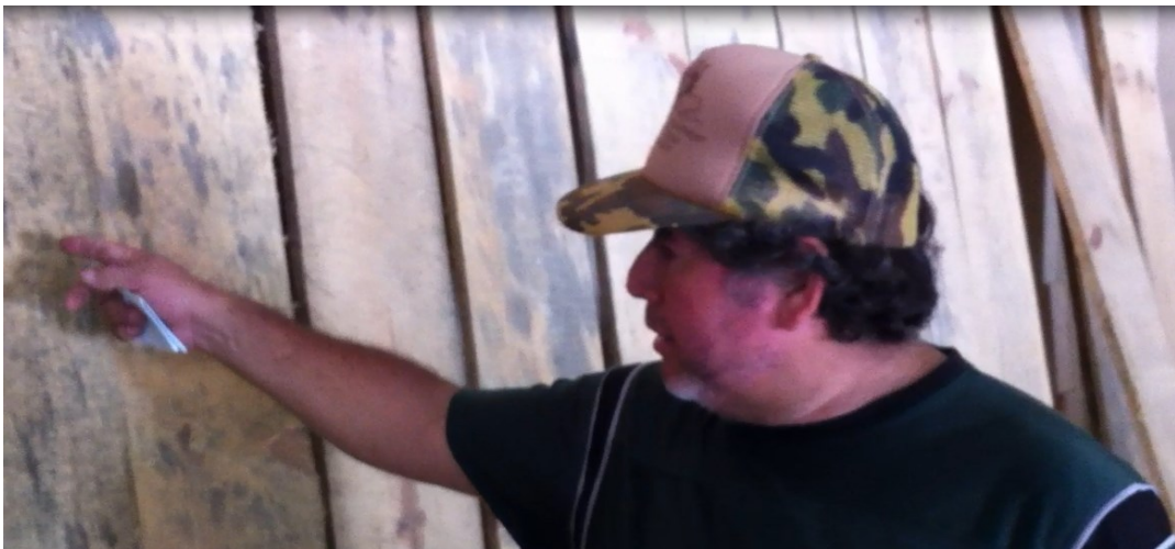
Hongos generados al introducir la madera directamente al colector solar sin realizar un pre-secado
