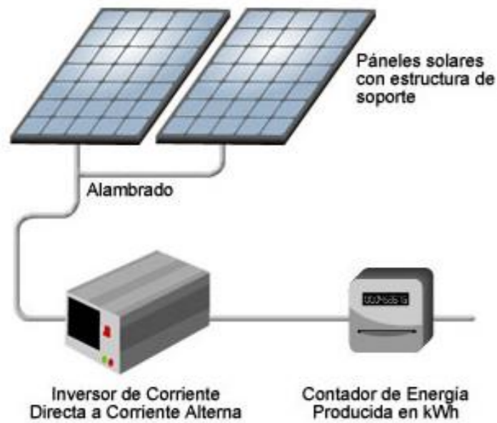
Fig. 121: Esquema funcionamiento panel solar. (Seesa, 2008)
