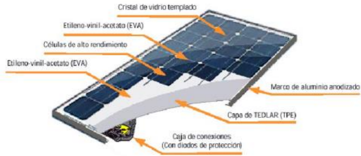
Fig. 120: Composición panel solar.(Seesa, 2008, p.3)
