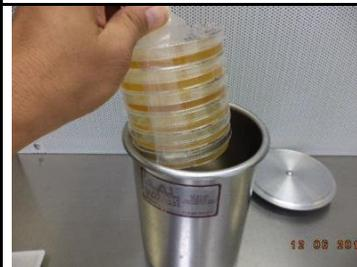
Se agregaron 35 ml de agua destilada en los cobres de anaerobiosis y se colocaron en las tinas para anaerobiosis.
