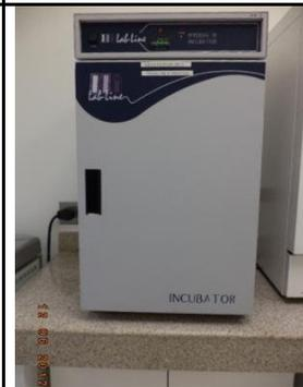
Para la incubación de bacterias acéticas, lácticas; se utilizo otra incubadora, la cual se ajusto a una temperatura de 42°C ± 2 grados
