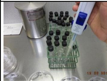
Las siembras se realizaron dentro de una cámara de flujo laminar, previamente esterilizada con lámpara ultravioleta.
